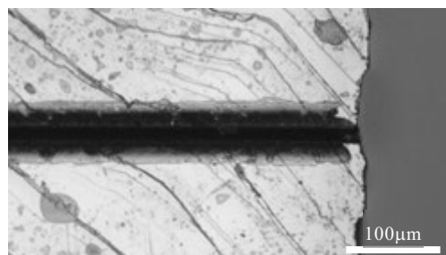
図 13 Ia タイプダイヤモンド UV レーザ照射 (3W, 1.0mm/s)
