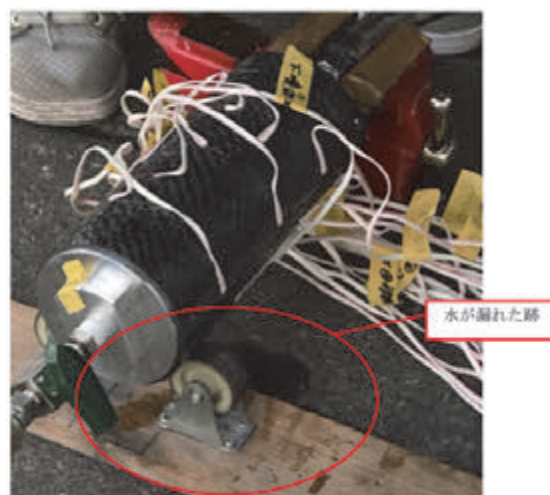
図 6 4.8MPa 負荷状況（漏洩状態）
